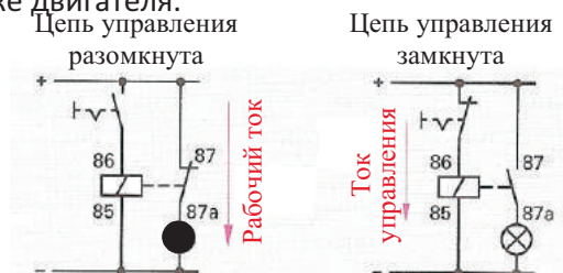
Рис.3: Размыкающее реле во включенном и выключенном состоянии
