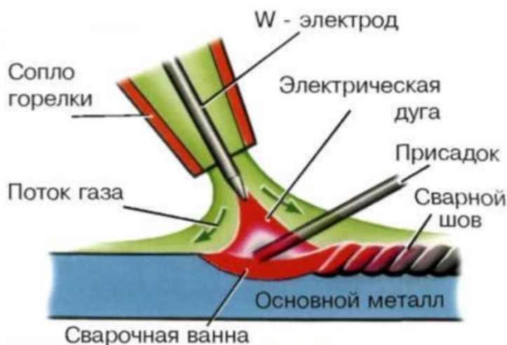
Рисунок 3 – Ручная аргонодуговая сварка неплавящимся вольфрамовым электродом
