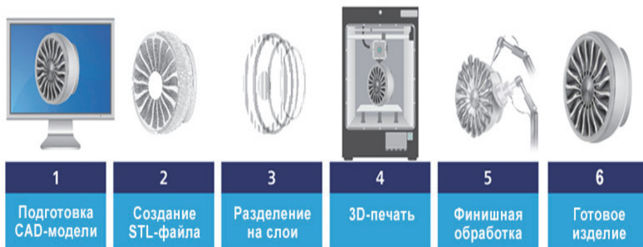
Рисунок 3 – Схема производства прототипа (аддитивная технология)
